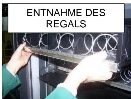
SICHERSTELLEN, DASS DIE KASSETTE VOLLSTÄNDIG ZURÜCKGESCHOBEN IST
